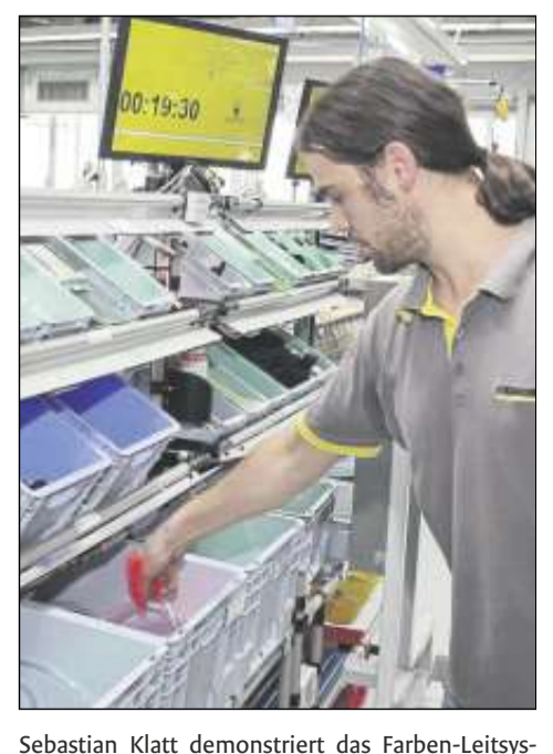
Sebastian Klatt demonstriert das Farben-Leitsystem der Einzelteilmontage an der neuen Linie. Am Bildschirm läuft der Takt – die Zeit, in der das Produkt fertig werden muss.
